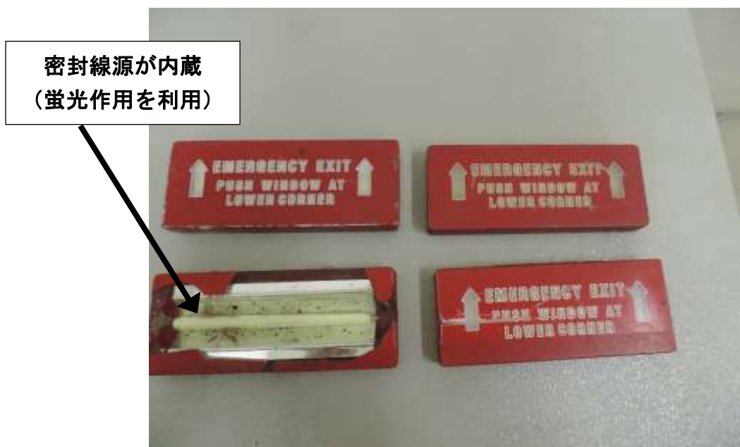
スライドドア下部に設置されていた非常口表示板
