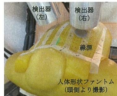
図 6.3.2-6 ^{241}\text{Am} 線源の測定風景
