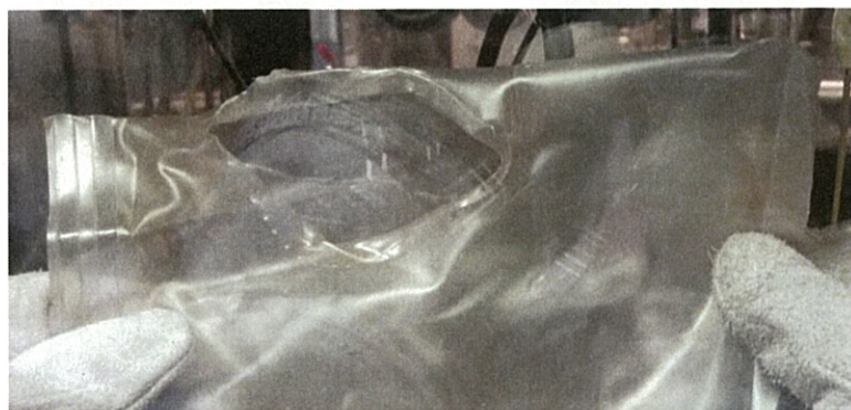
二重目 (外側) の樹脂製の袋頂部の開口部分 (H29. 8. 2撮影)
