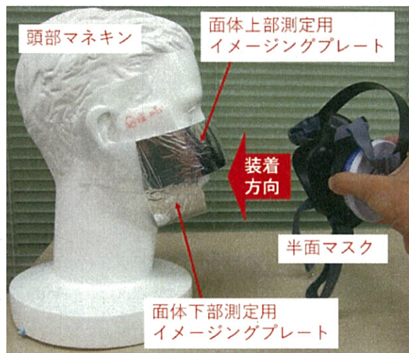
図 6.5.3-4-1 マスクのイメージングプレートへの露光方法
