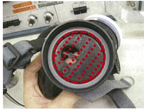
図 6.5.3-5-2 乾式スミヤ試料採取箇所
