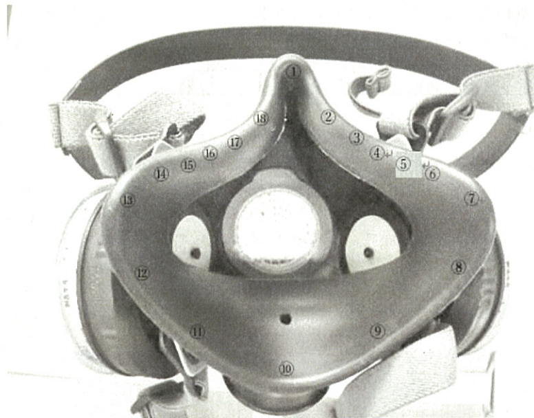
図 6.5.3-2-2 半面マスク測定箇所
