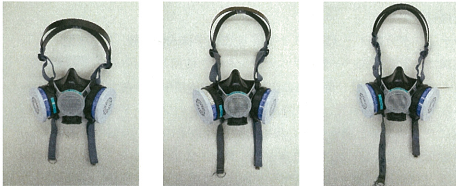
図 6.5.4-2 試験に使用した半面マスク （しめひもの伸縮性 左：良、中：やや不良、右：不良）
