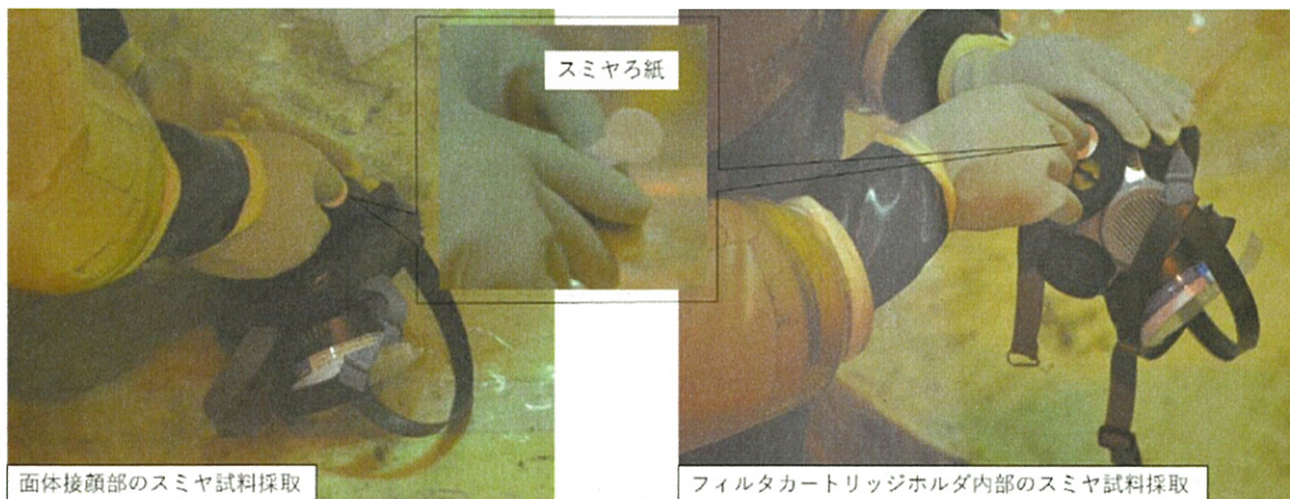
図 6.5.3-3-1 半面マスクのスミヤ試料採取の様子
