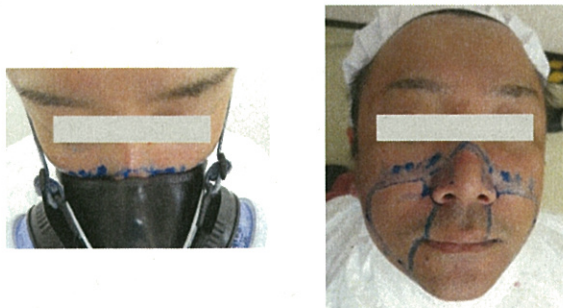
図 6.5.4-4 水分による侵入の確認結果 （漏れ率高、左：粉末+水分付着直後、右：5分後） ⇒ 侵入有
