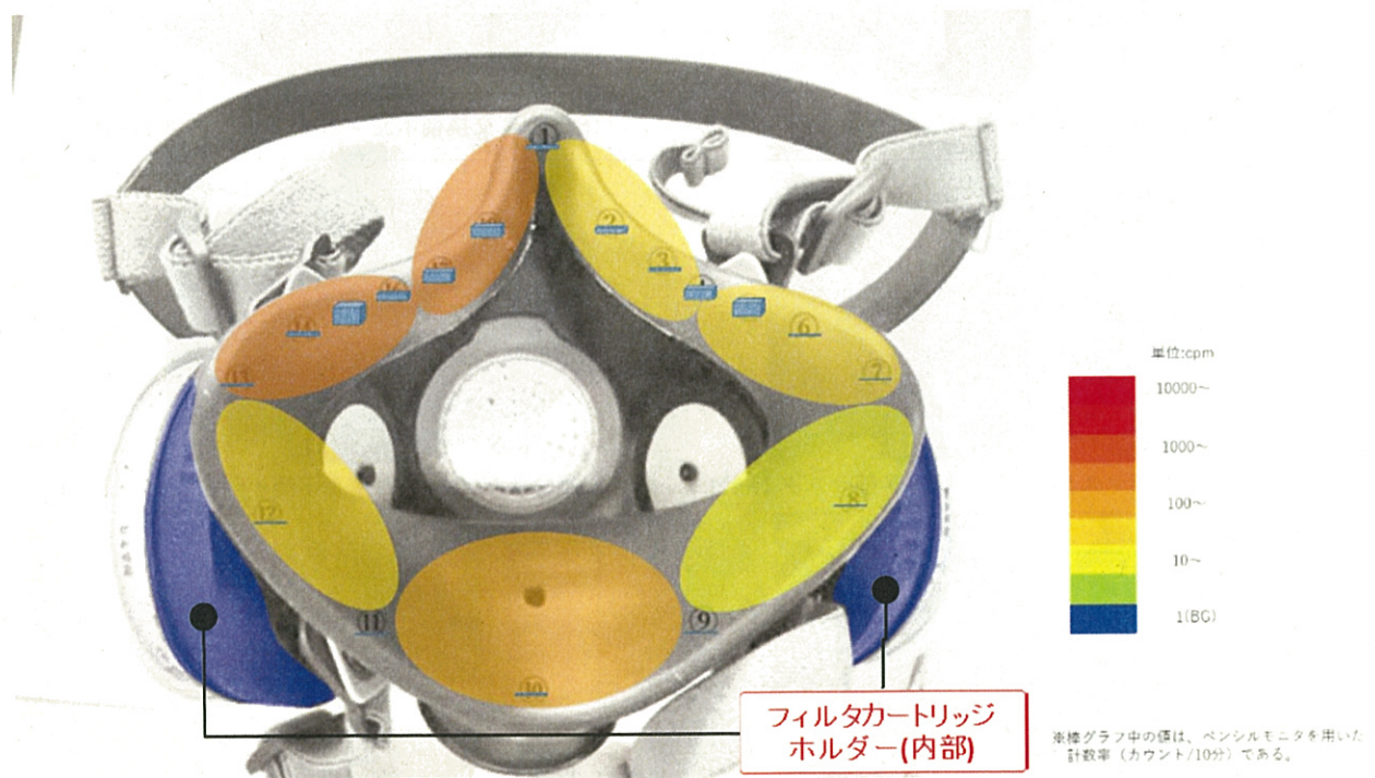
図 6.5.3-3-7 作業員 E の交換後半面マスク(半面マスク No.2)の測定結果
