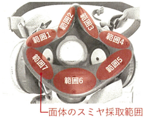
図 6.5.3-5-1 湿式スミヤ試料採取箇所
