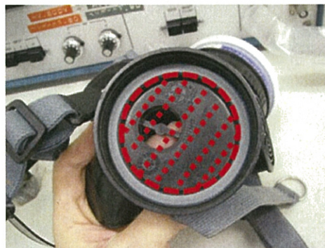
図 6.5.3-3-3 乾式スミヤ試料採取箇所
