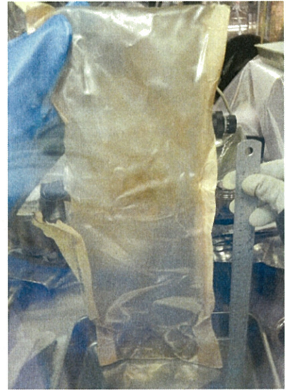
図 7.1.3-12 事象発生時の当該樹脂製の袋の観察結果（左図：二重目，右図：一重目）
