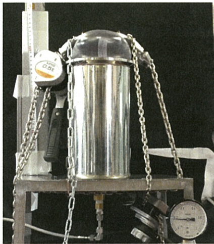
図 7.1.3-参 11 樹脂製の袋が膨張する様子と破損状態 No. 5 (直線)
