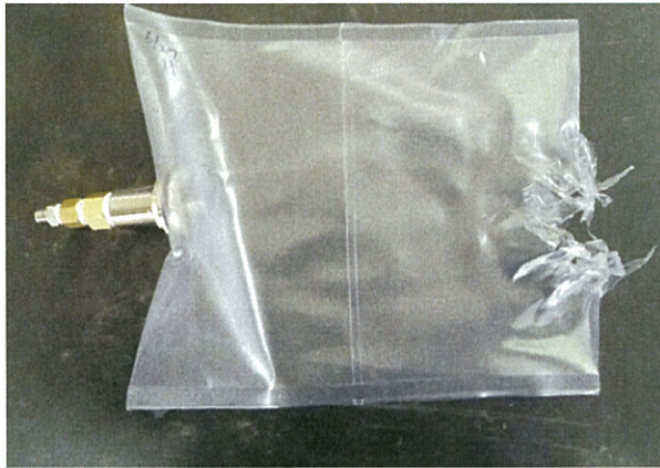
図 7.1.3-参 5 破裂状態の例 No. 9 (放射状)
