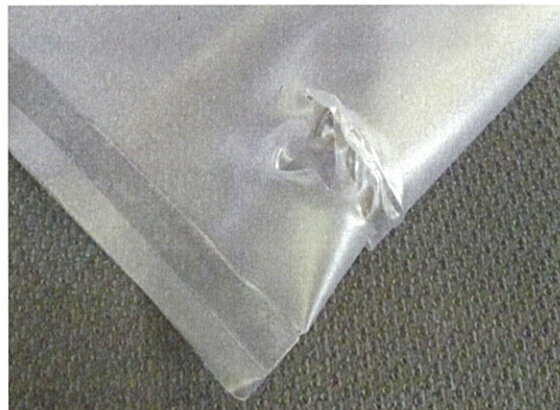
図 7.1.3-参 11 樹脂製の袋が膨張する様子と破損状態 No. 5 (直線)
