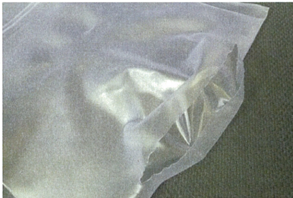
図 7.1.3-参 6 破裂状態の例 No. 10 (直線)
