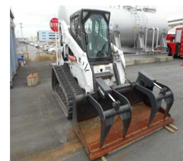
ルート整備用の重機
