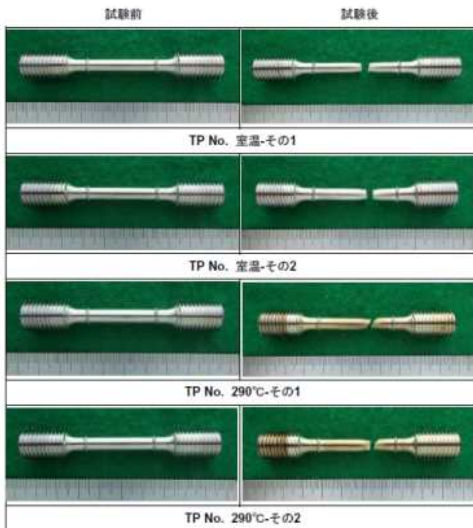
図 5.2.2-4 引張試験前後の試験片の外観
