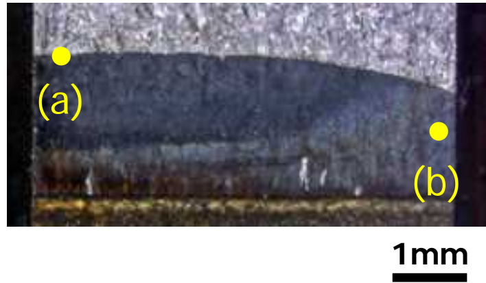
図 5.2.1-17 CT 試験片(6TLA)の TEM 観察用試験片採取位置 (a)板厚中央き裂先端 (b)サイドグループ脇
