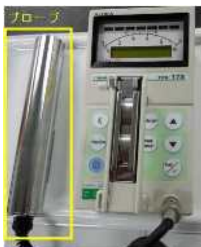
<図2> NaI(Tl)シンチレーションサーベイメータの一例
