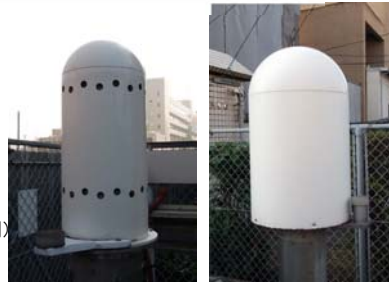
NaI(Tl)シンチレーション検出器（左側） 電離箱検出器（右側）
