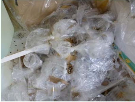
試料容器の破損状況
