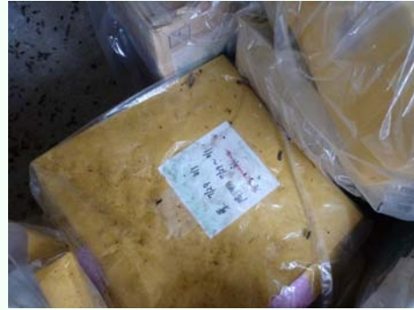
試料の糞尿被害状況
