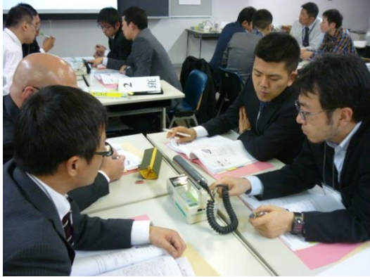
空間線量率測定（測定器の取り扱い）
