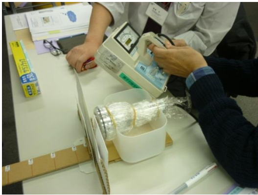
放射線測定実習（放射線の性質：距離）
