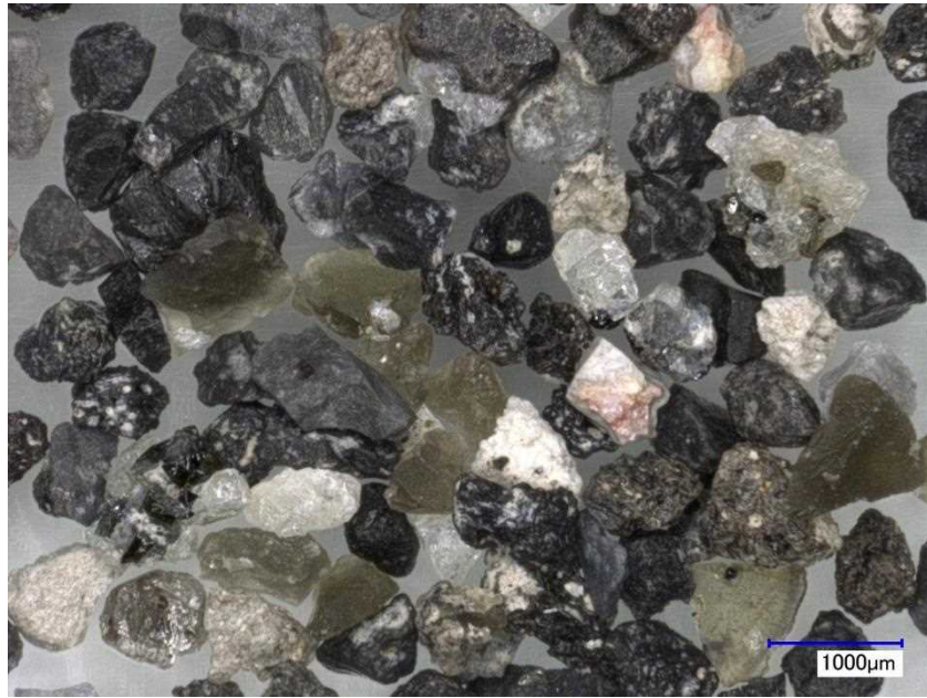
図 2. 2-4 : Aso2014a-C の顕微鏡写真. 500~1000 \mu\text{m} に篩分けた粒子.
