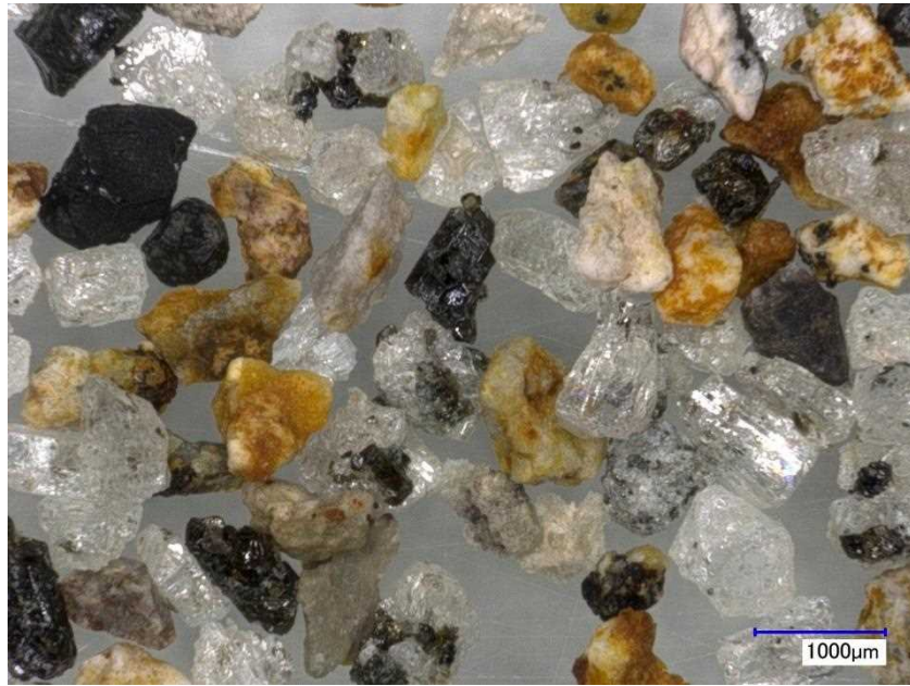
図 2. 2-6 : Aso2014a-E の顕微鏡写真. 500~1000 \mu m に篩分けた粒子.
