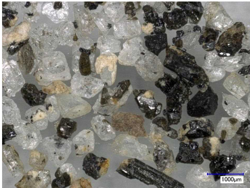
図 2. 2-4 : Aso2014a-C の顕微鏡写真. 500~1000 \mu\text{m} に篩分けた粒子.
