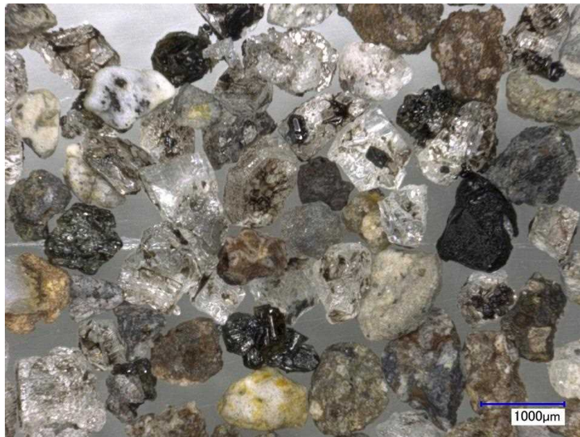
図 2. 2-7 : Aso2014a-A の顕微鏡写真. 500~1000 \mu m に篩分けた粒子.
