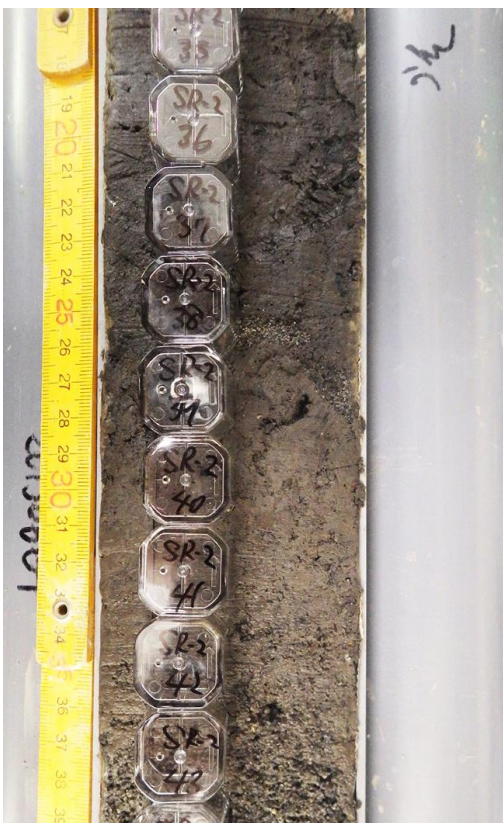
図 2-3-4 : キューブを用いた試料採取の様子.
