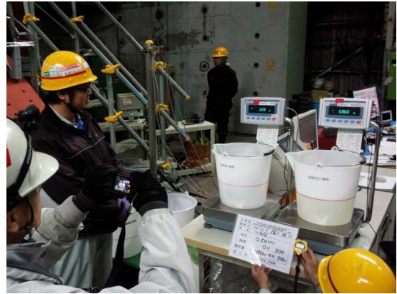
(漏水量の計測)
