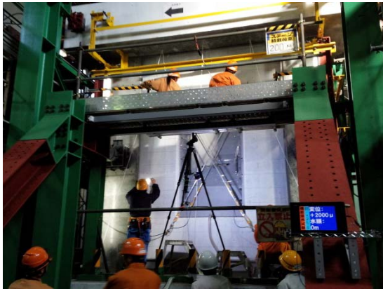
(躯体損傷・漏水状況の観察)
