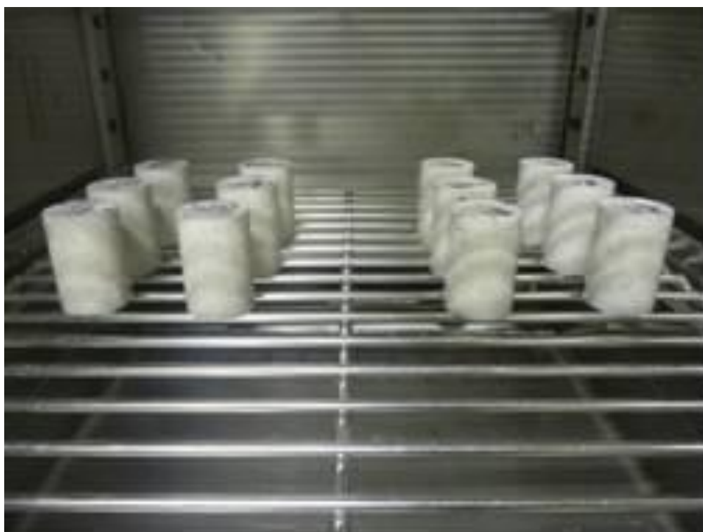
図 3. 1. 1-25 試験体設置状況（照射試験 4 列目模擬）
