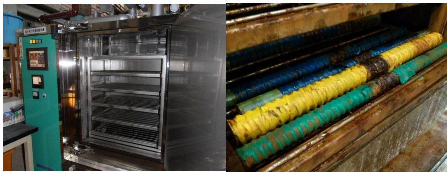
図 2.4.2-4 塩水噴霧試験の様子
