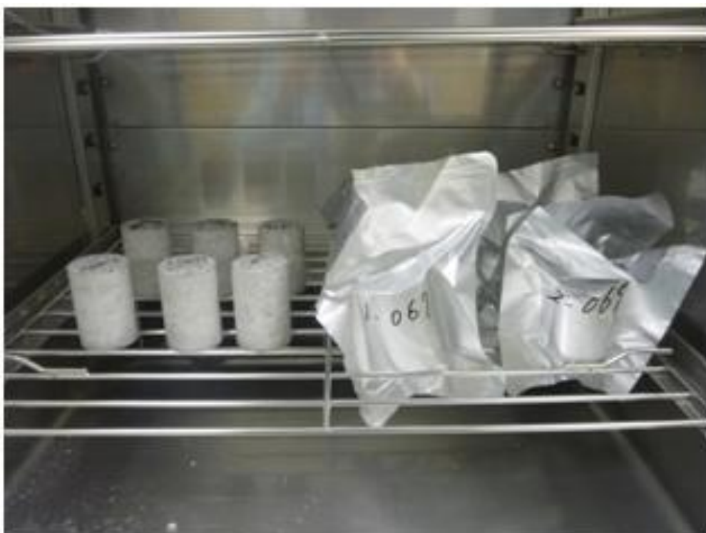
図 3. 1. 1-23 試験体設置状況（照射試験 1 列目模擬）
