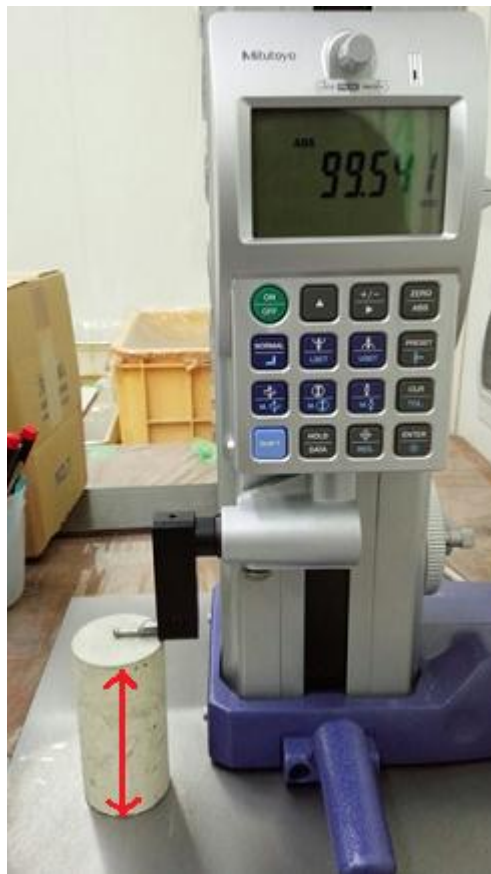
図 3.3.2-1 試験体長さの測定の様子
