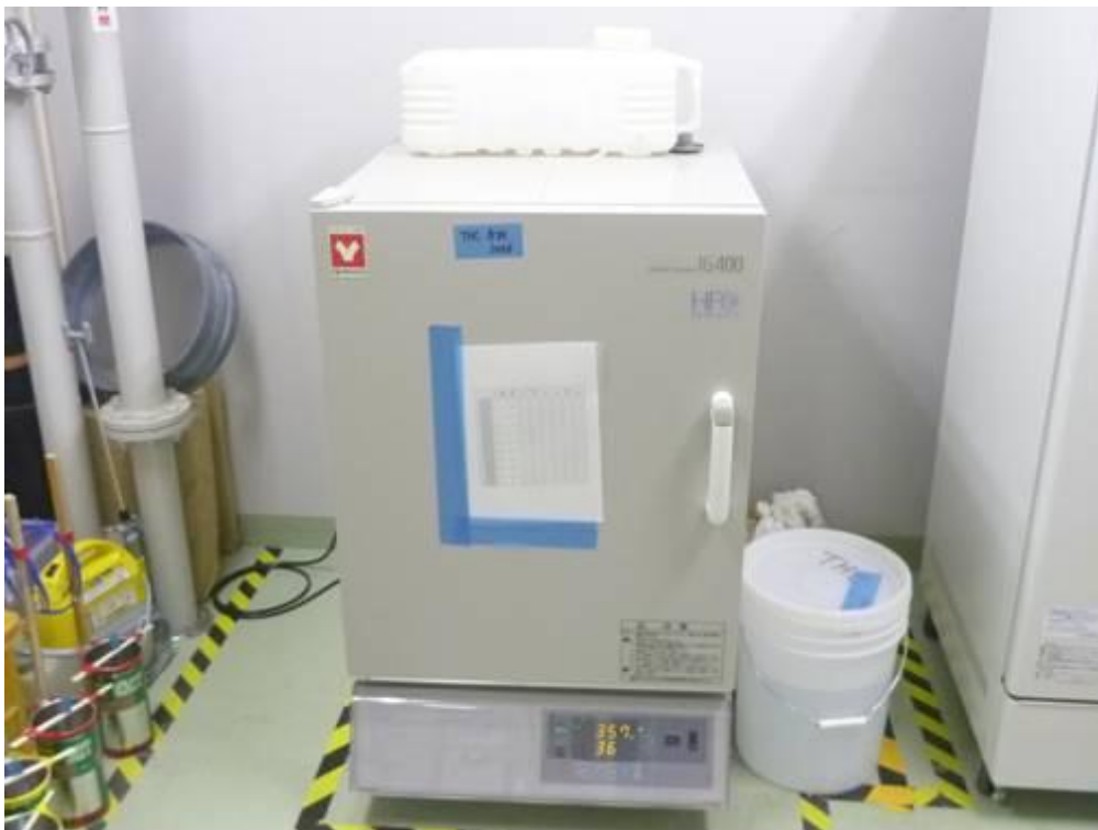
図 3. 1. 1-22 恒温恒湿槽：IG400（照射試験 1 列目模擬）
