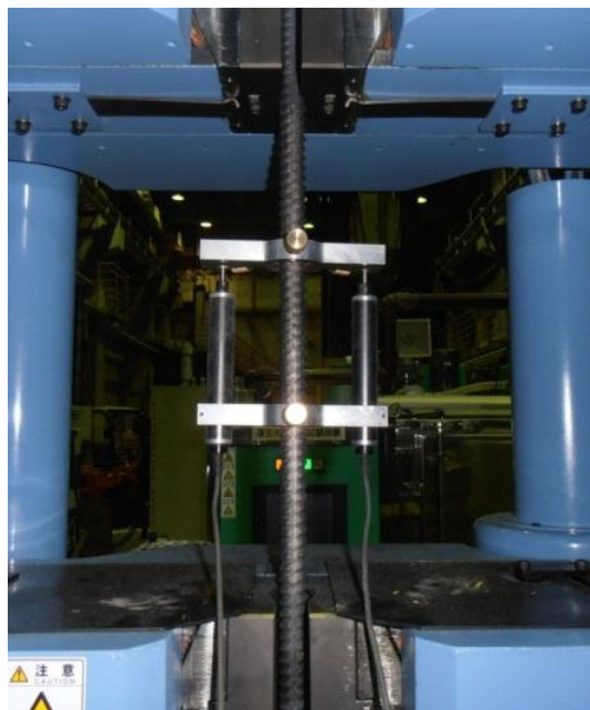
図 2.4.2-8 引張試験状況
