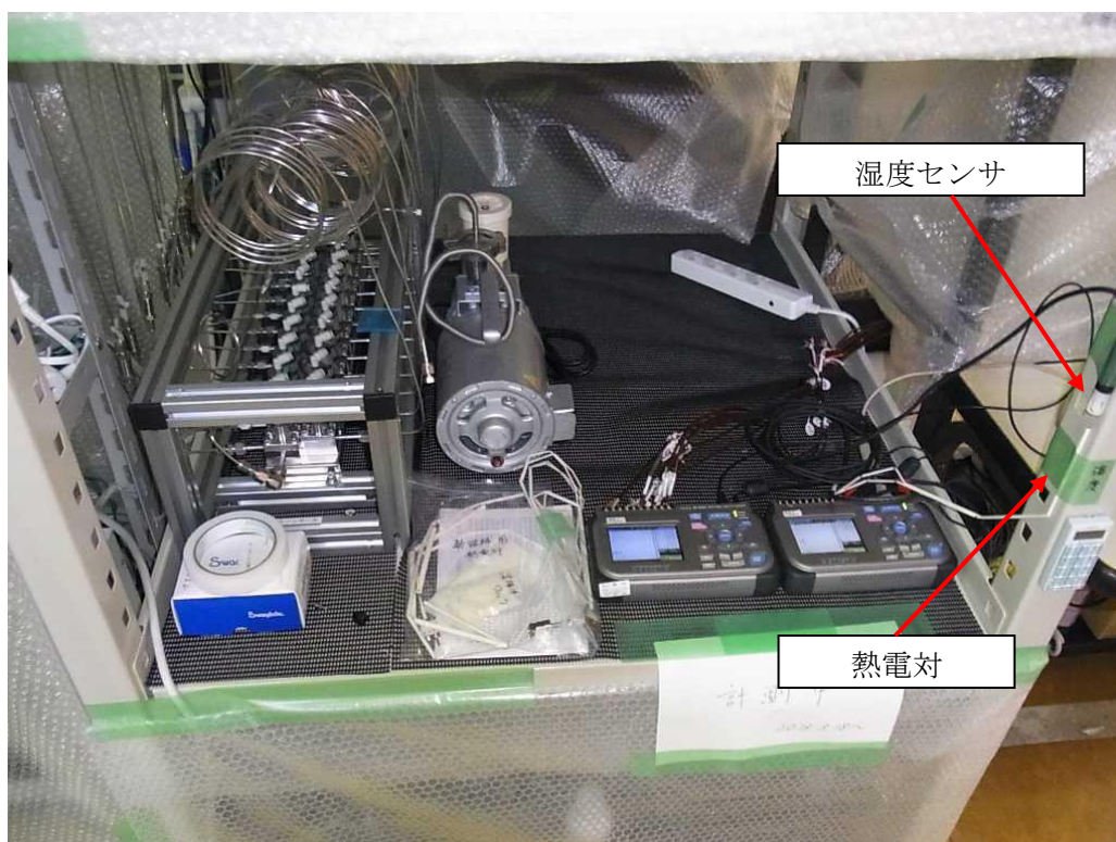
図 3. 1. 1-10 照射室外湿度センサおよび熱電対設置箇所
