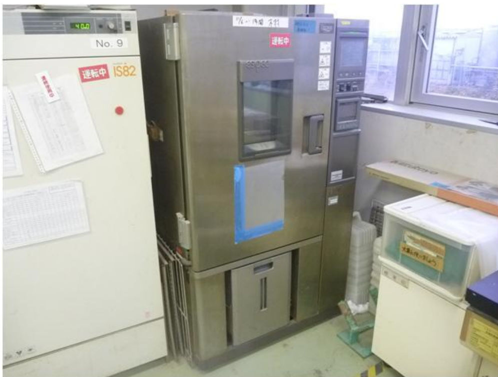
図 3. 1. 1-24 恒温恒湿槽：PR-2K（照射試験 4 列目模擬）
