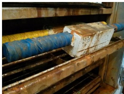
図 2.4.2-5 ひび割れを有するモルタル供試体の塩水噴霧試験の様子
