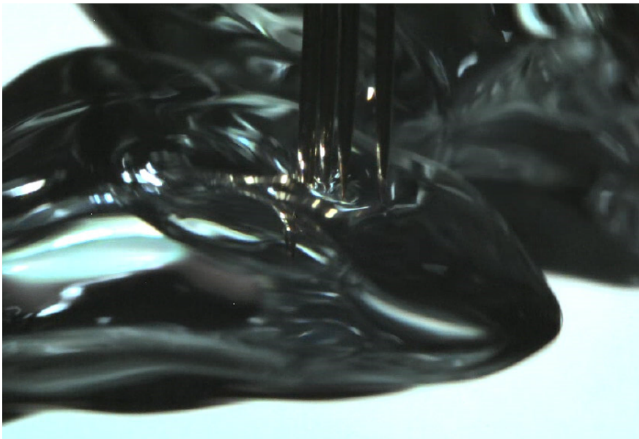
図 4.2.3-2 プローブ貫通時の気液界面の変形
