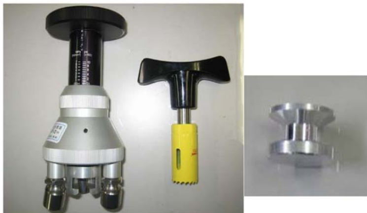
プルオフ法の試験機材 (左: 付着力試験器、中: ドリーカッター、右: ドリー)
