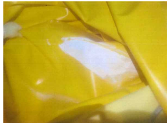
バルーン上面 (雨カバー下部) に飛散防止剤の滞留跡あり
