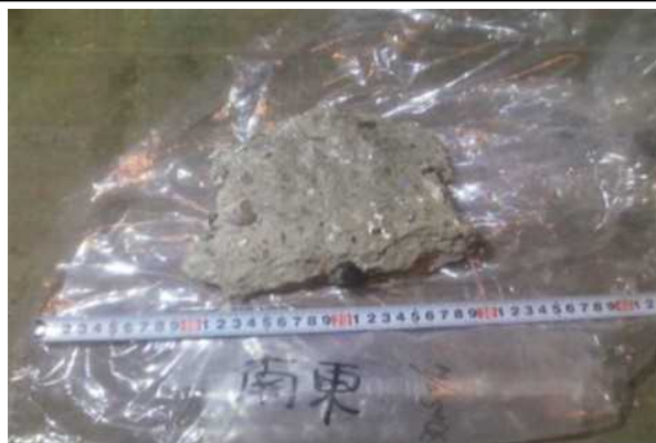
コンクリート片 約200×150×t50 (約3.5kg)
