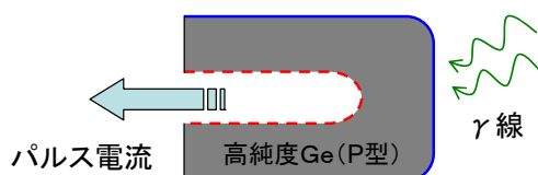
図1 Ge半導体検出器の測定原理（イメージ）
