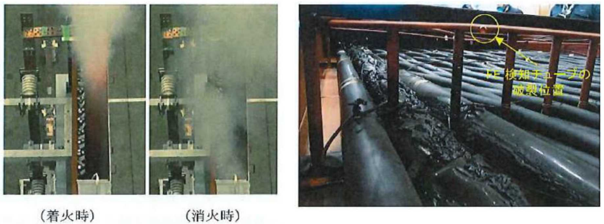
第 13 図 試験 V2 における発火・消火時の状態
