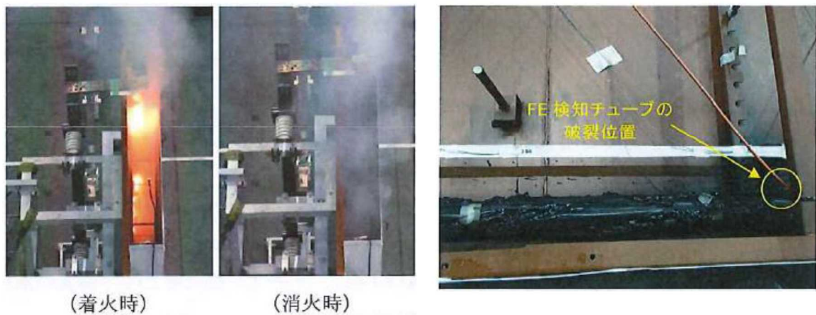
第 11 図 試験 V1 における発火・消火時の状態
