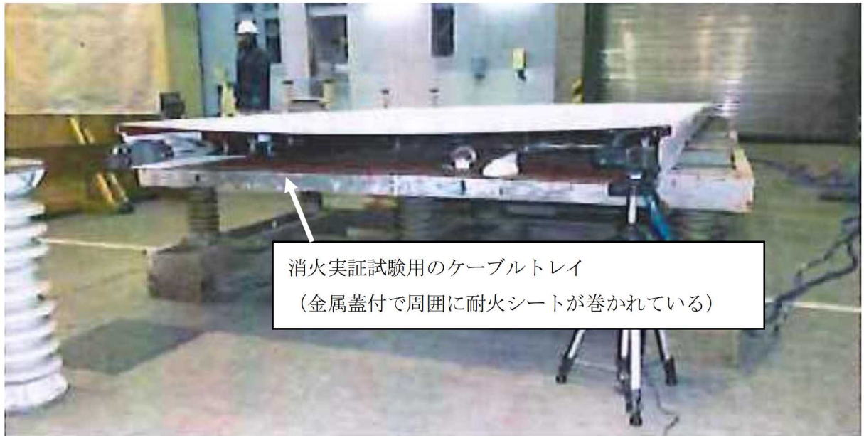
第5図 消火実証試験用のケーブルトレイ外観
