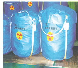
フレキシブルコンテナに詰めたコンクリート廃棄物
