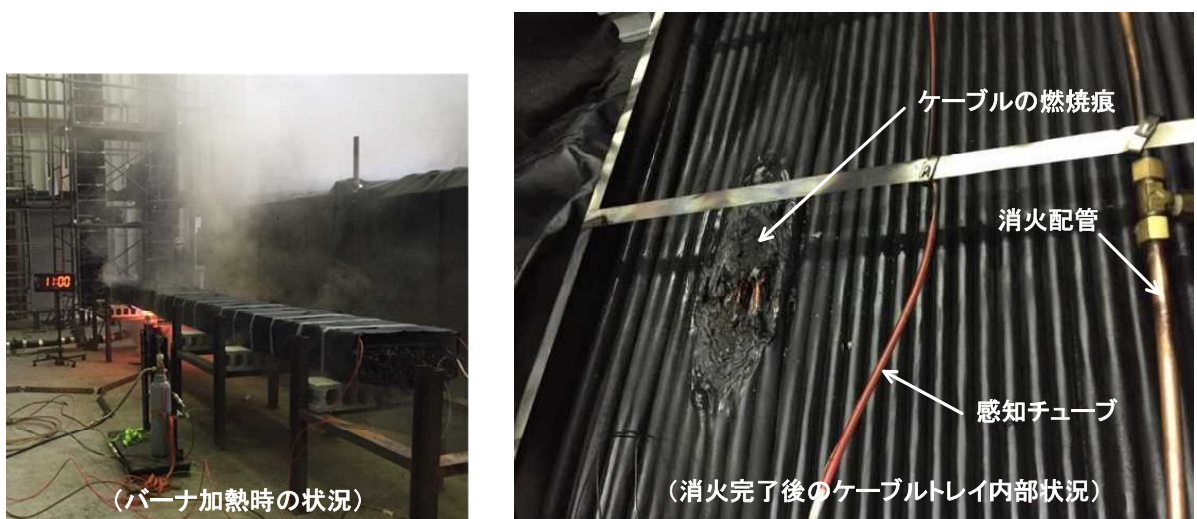
第 16 図 加熱時及び消火後の状態
