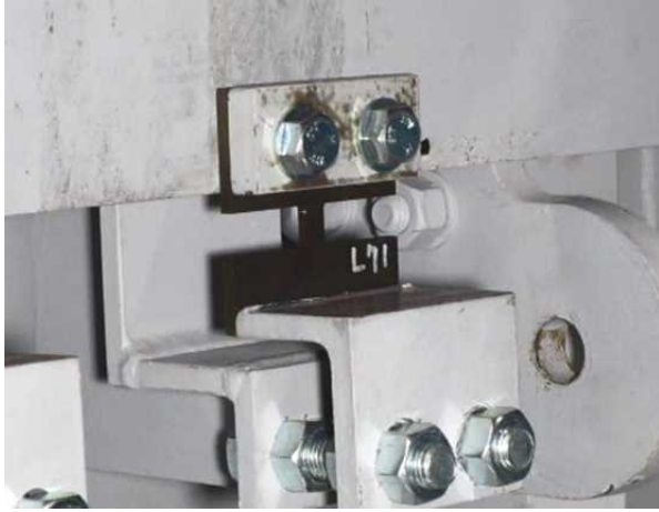
図 2-1 止板の固定状態及び開放後の状態
