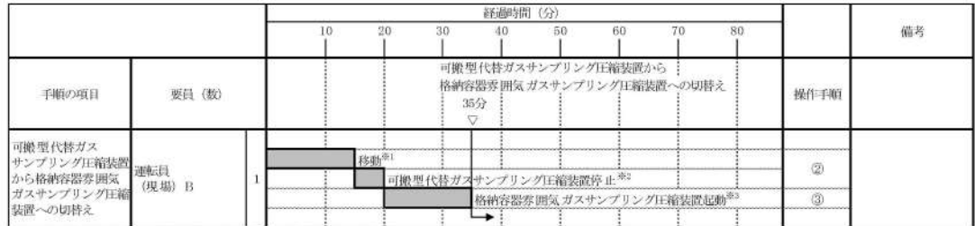
第 1.9.12 図 ガス分析計による原子炉格納容器内の水素濃度監視 タイムチャート
