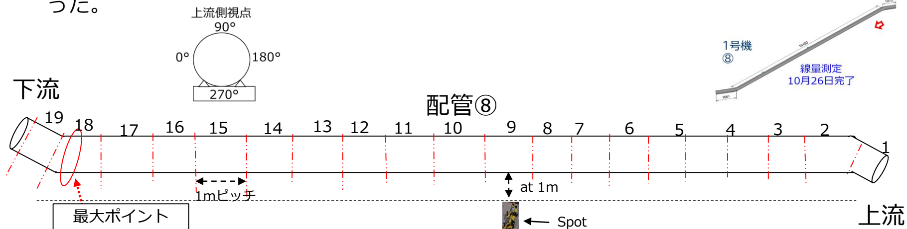
配管表面よりat 1m ※1mピッチで測定を行い、1mピッチ内の最大線量率を記載 単位：mSv/h
