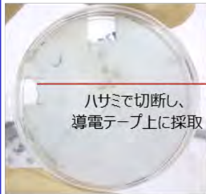
付着物 (スミア) 外観 SEM試料採取後
