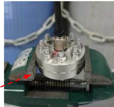
図5 気密性確認試験状況
