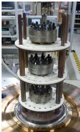
図4 蒸気曝露 試験片設置状況
