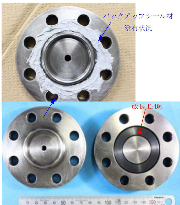
図 12 試験体の状況 (改良 EPDM 製シール材＋バックアップシール材)
