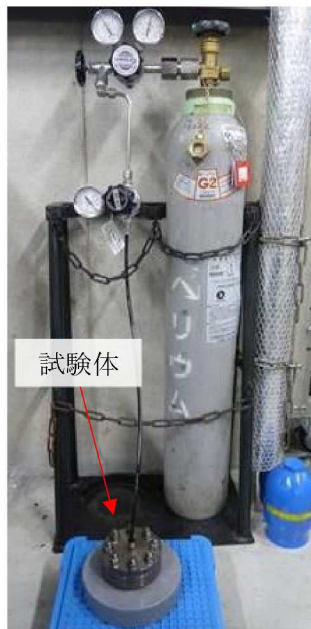
図5 He気密性確認試験状況
