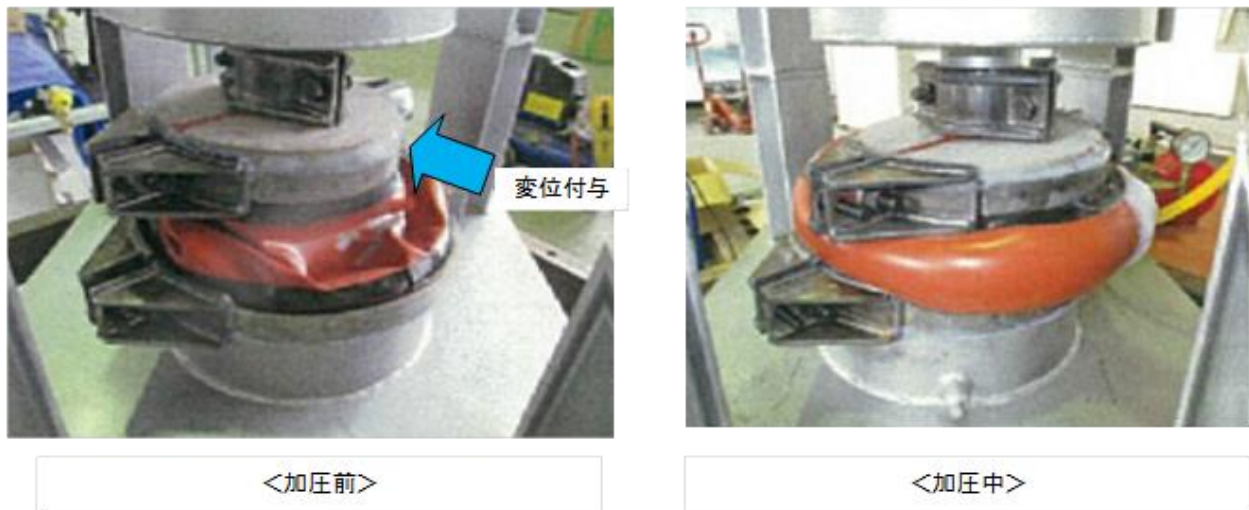
図4-5 漏えい試験概要図（ブーツ）
