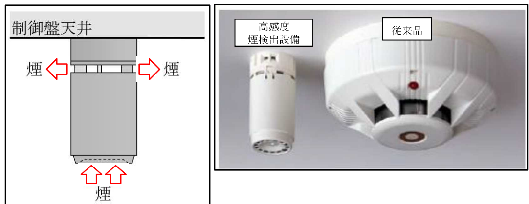
第 3-10 図 高感度煙検出設備の概要
