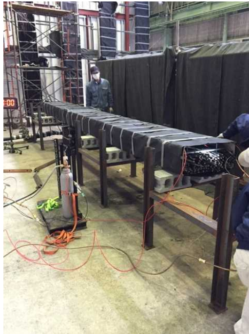
第 15 図 消火実証試験用（金属蓋なし）のケーブルトレイ外観
