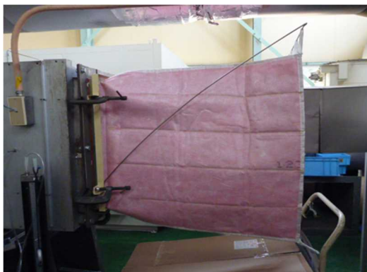
図1 バグフィルタの耐荷重試験の様子
