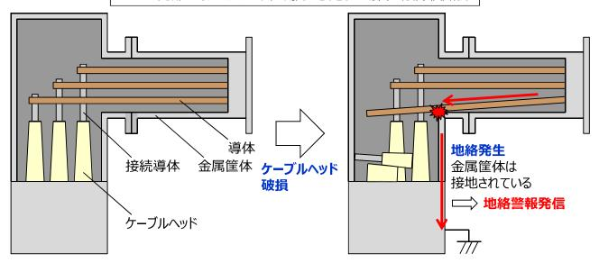
相分離母線の構造上、内部の導体が切断するようなモードは想定しにくいため、内部で1相開放故障が発生することは考えにくい。
