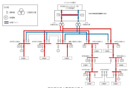
再処理施設の電源系統構成
