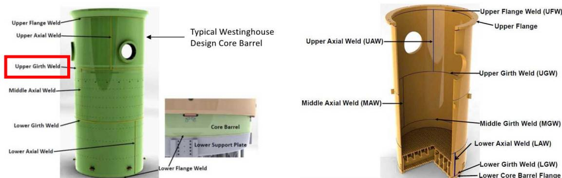
図 2 炉心そうの模式図<sup>12</sup>
