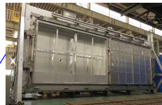
燃料取替床ブローアウトパネル閉止装置 （待機状態，取付前）
