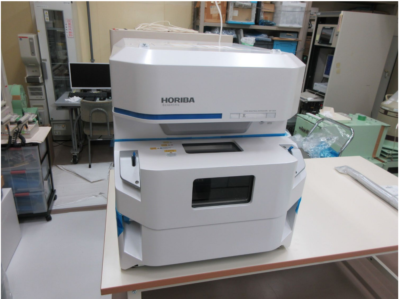
図-3. 1: 元素分布測定装置の外観
