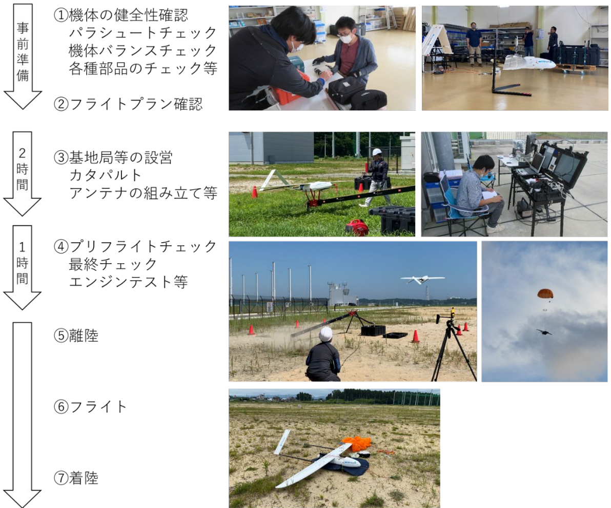
Fig. 6-4 フライト試験の工程
