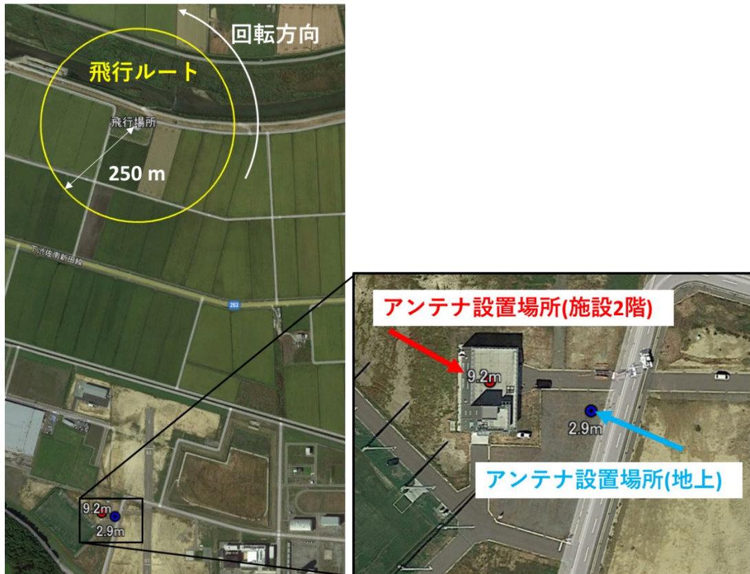
Fig. 6-9 通信試験アンテナ設置場所
