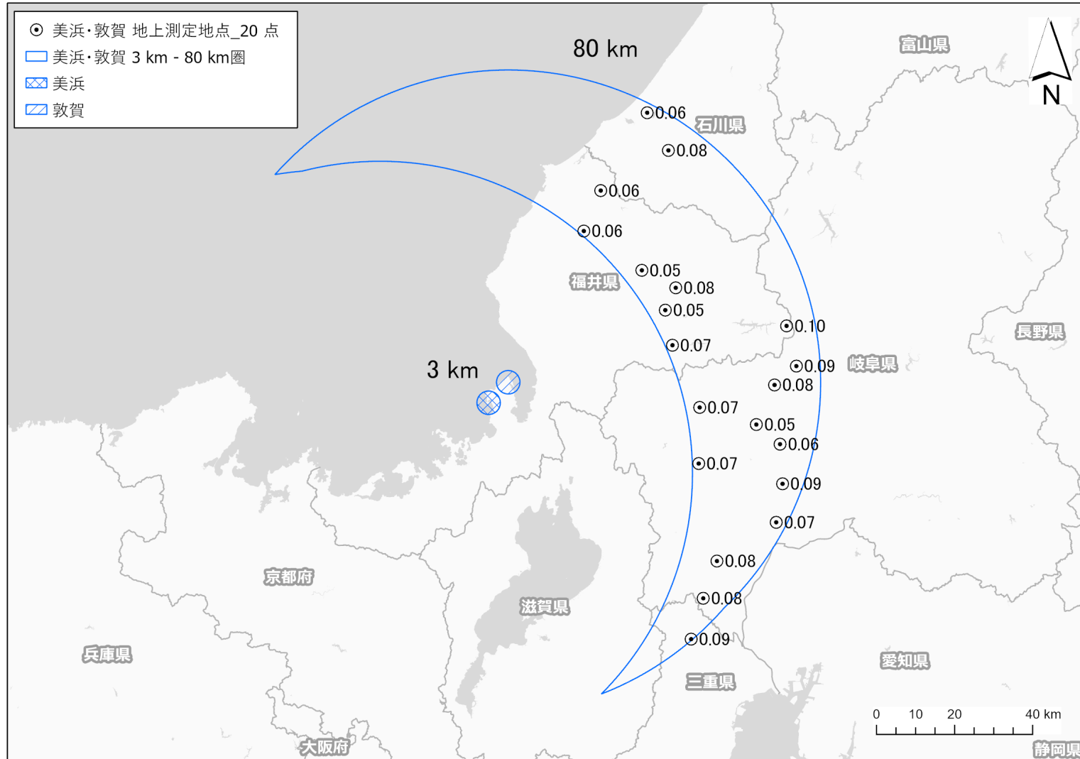
Fig. 4-4 美浜・敦賀の測線近傍における地上測定値 (μSv/h) (背景地図は、ESRI ジャパン データ コンテンツ (c) Esri Japan) を使用。)
