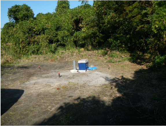
図 1-2-8. 高免アレイ観測点の例 (BKOM6 地点 6)。青色ボックスにロガーおよびバッテリーを収容する。青色ボックスの左側の灰色のパイプが地震計孔口。孔中地震計は地表から 10m の孔底に設置された。(京都大学防災研究所, 2021)
