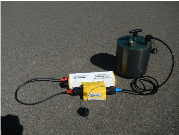
図 1-2-9. 地表観測点機材。白色機材はバッテリー、黄色機材は記録装置 GSR-3LF、濃緑色の円筒形機材は地表用 3 成分地震計 GS-1LF。(京都大学防災研究所, 2021)
