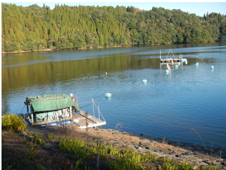
図1-2-5. エアガンポンツーン(上右)とコンプレッサ船(左下)。コンプレッサ船上には高圧コンプレッサとマニホールドを搭載した。
