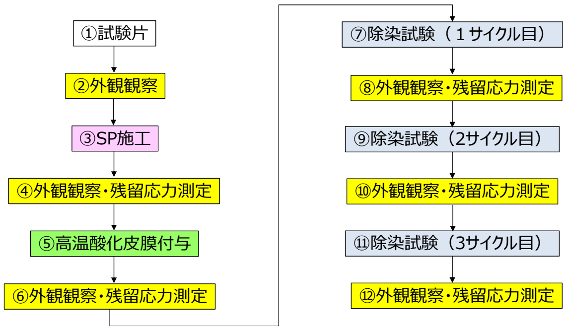
図 3. 3. 1. 1 (2)-11 残留応力測定による評価フロー (30×30×5t mm 試験片)
