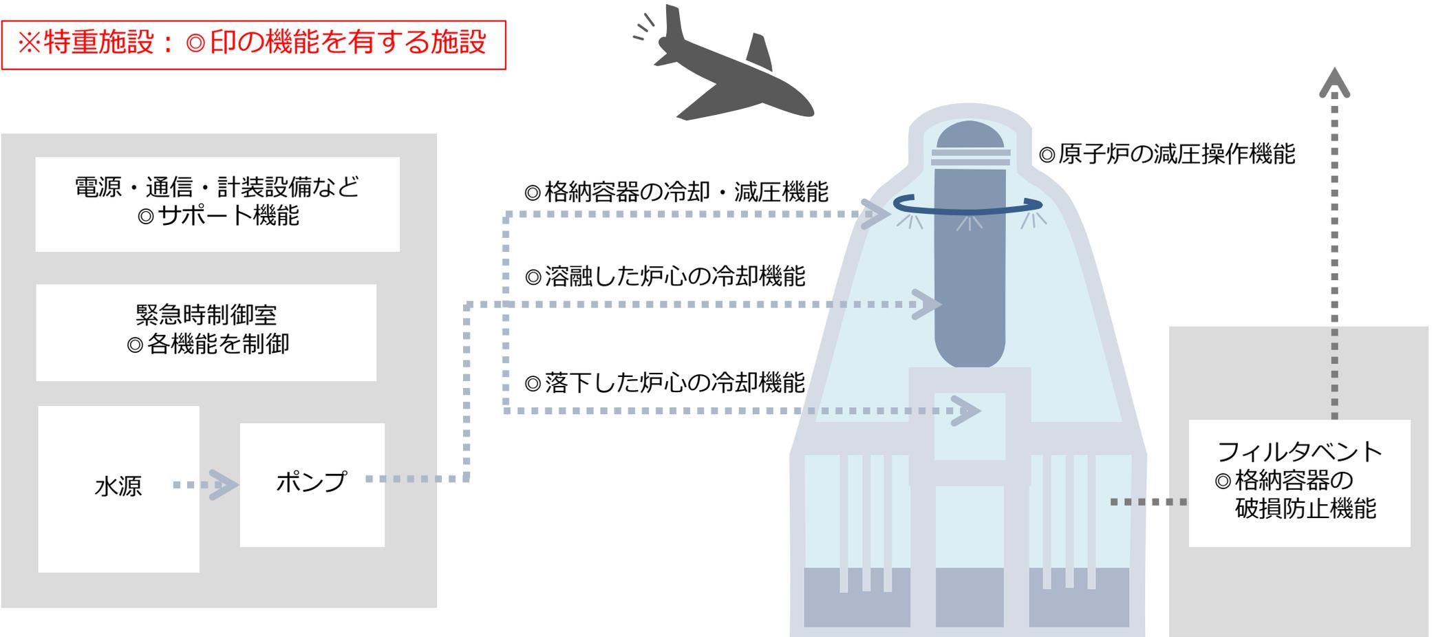
◎各機能の詳細は「実用発電用原子炉及びその附属施設の位置、構造及び設備の基準に関する規則の解釈」を参照
