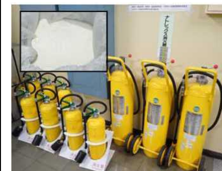
可搬型消火器 (特殊化学消火剤)
