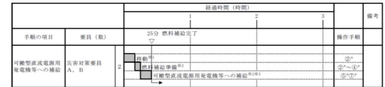
図 2.14.34 燃料タンク (SA) から可搬型タンクローリーへの燃料補給のタイムチャート*
