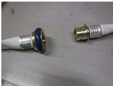
消防ホース (40A) 接続前
