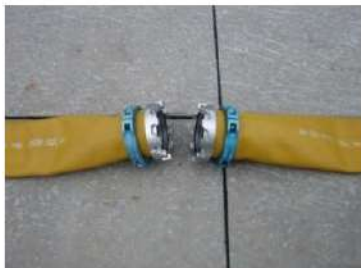
可搬型ホース(150A) 接続前
