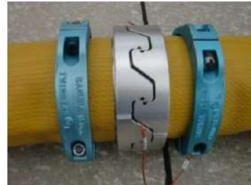
可搬型ホース(150A)接続後
