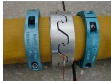
可搬型ホース (150 A) 接続後
