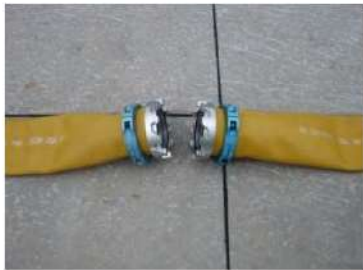
可搬型ホース(150A)接続前
