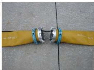
可搬型ホース（150A）接続前
