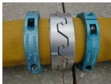
可搬型ホース（150A）接続後
