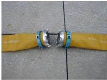
可搬型ホース(150A)接続前
