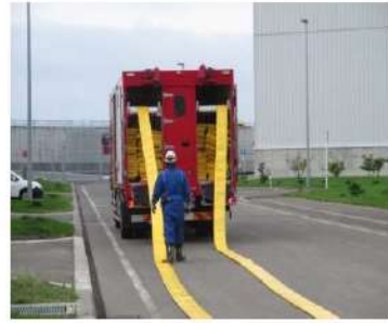
ホース延長・回収車（送水車用）による 可搬型ホース敷設 （屋外）
