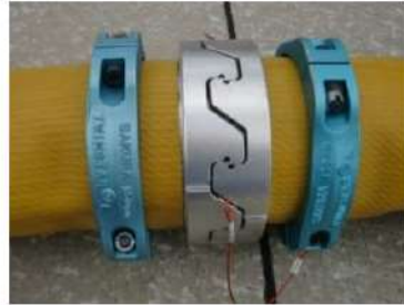
可搬型ホース（150A）接続後
