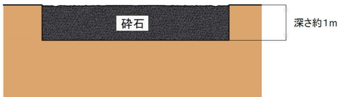
段差復旧用の碎石の配備イメージ
