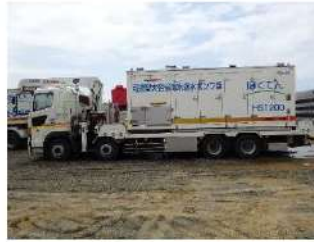
可搬型大容量海水送水ポンプ車
