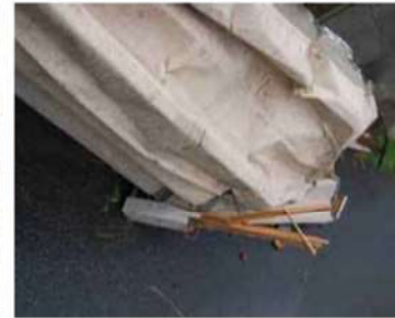
飛散した折板屋根の状況
