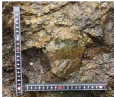
P5 防災科研調査において地滑り土塊末端部とされる箇所付近の沢の露岩状況 堅硬な岩盤（凝灰角礫岩）が認められる。
