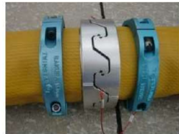
可搬型ホース（150A）接続後
