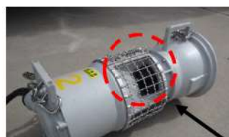
①水中ポンプの吸込み部
