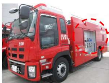
②可搬型大型送水ポンプ車の吸込み部（水中ポンプからのホース接続部）
