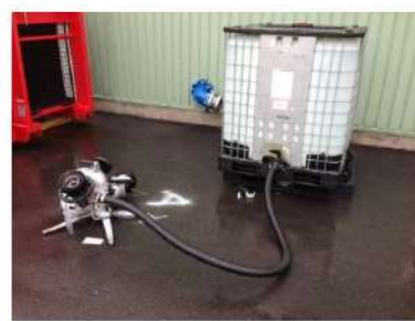
小型放水砲及び泡消火薬剤
