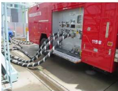
可搬型大型送水ポンプ車の設置 ポンプ車周辺のホース敷設 (屋外)
