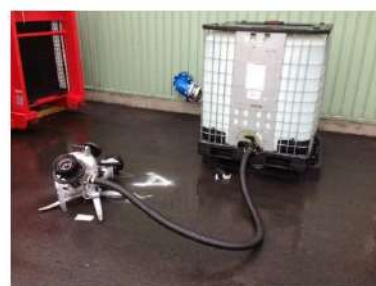
小型放水砲及び泡消火薬剤
