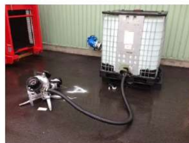
小型放水砲及び泡消火薬剤
