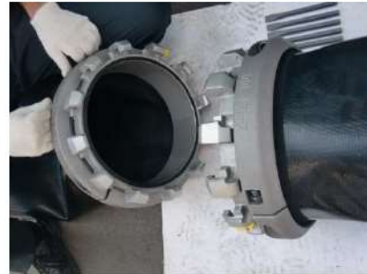
可搬型ホース (300A) 接続
