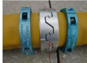
可搬型ホース(150A)接続後
