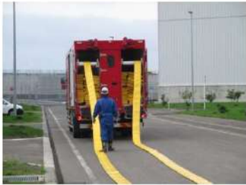
ホース延長・回収車（送水車）による 可搬型ホース敷設 （屋外）
