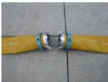
可搬型ホース(150A) 接続口
