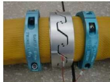
可搬型ホース(150A)接続後
