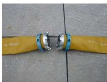
可搬型ホース(150A) 接続前
