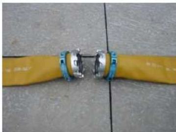
可搬型ホース (150A) 接続前
