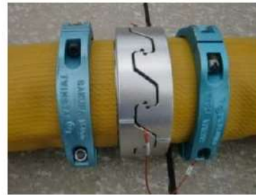
可搬型ホース(150A)接続後
