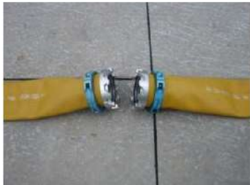
可搬型ホース (150A) 接続前
