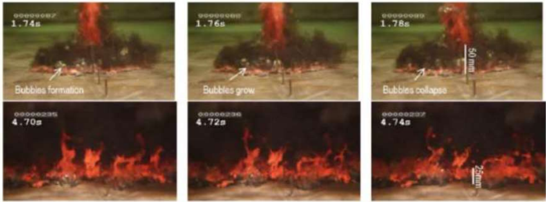
図 3.1-55 PULiMS-E4 試験での溶融物拡がり挙動
